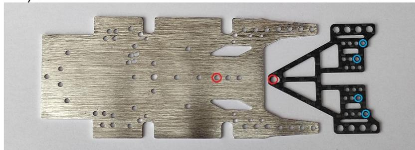
Legende: Rote Kreise: Position der hinteren T-Hülse. Position der vorderen T-Hüls-freigestellt. Blaue Kreise: Verschraubungspunkte der Achsböcke.
